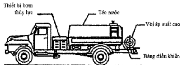
Hình 6-5 Cấu tạo thiết bị vệ sinh ống thoát nước
